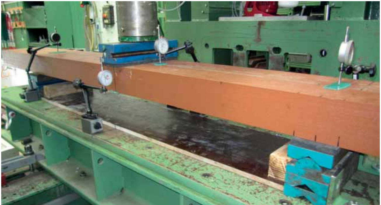
Statische Prüfung in Schwellenmitte
