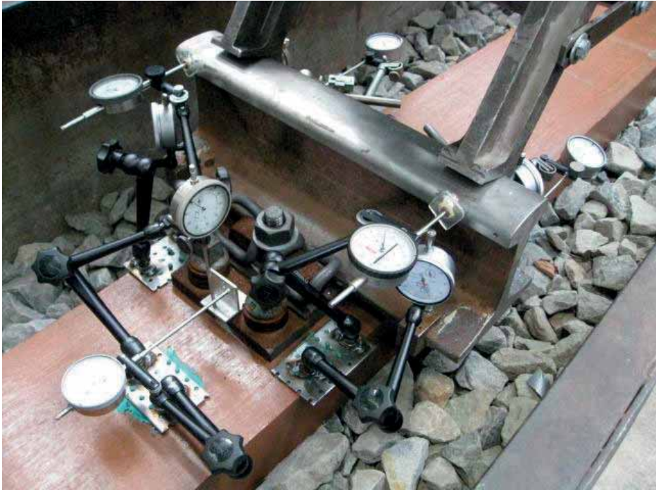
Scherenhebelschwingversuch in Anlehnung an DIN EN 13481-3
