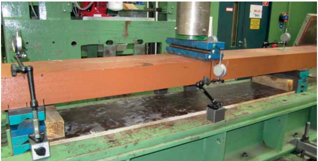
Ermüdungsprüfung in Schwellenmitte (2,0 Mio. Lastspiele)
