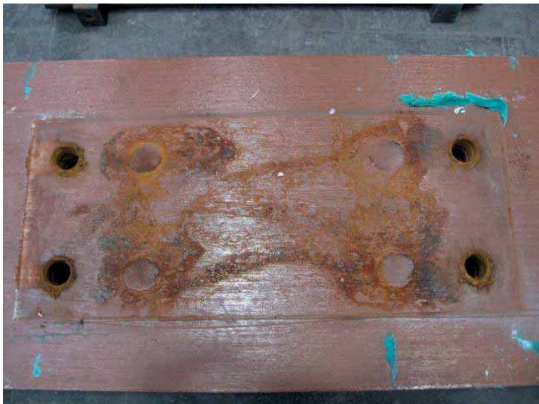
Geringfügige plastische Verformungen von maximal 0,23 mm an der Schwellenoberfläche nach dem Scherenhebelversuch (3,0 Mio. Lastspiele)
