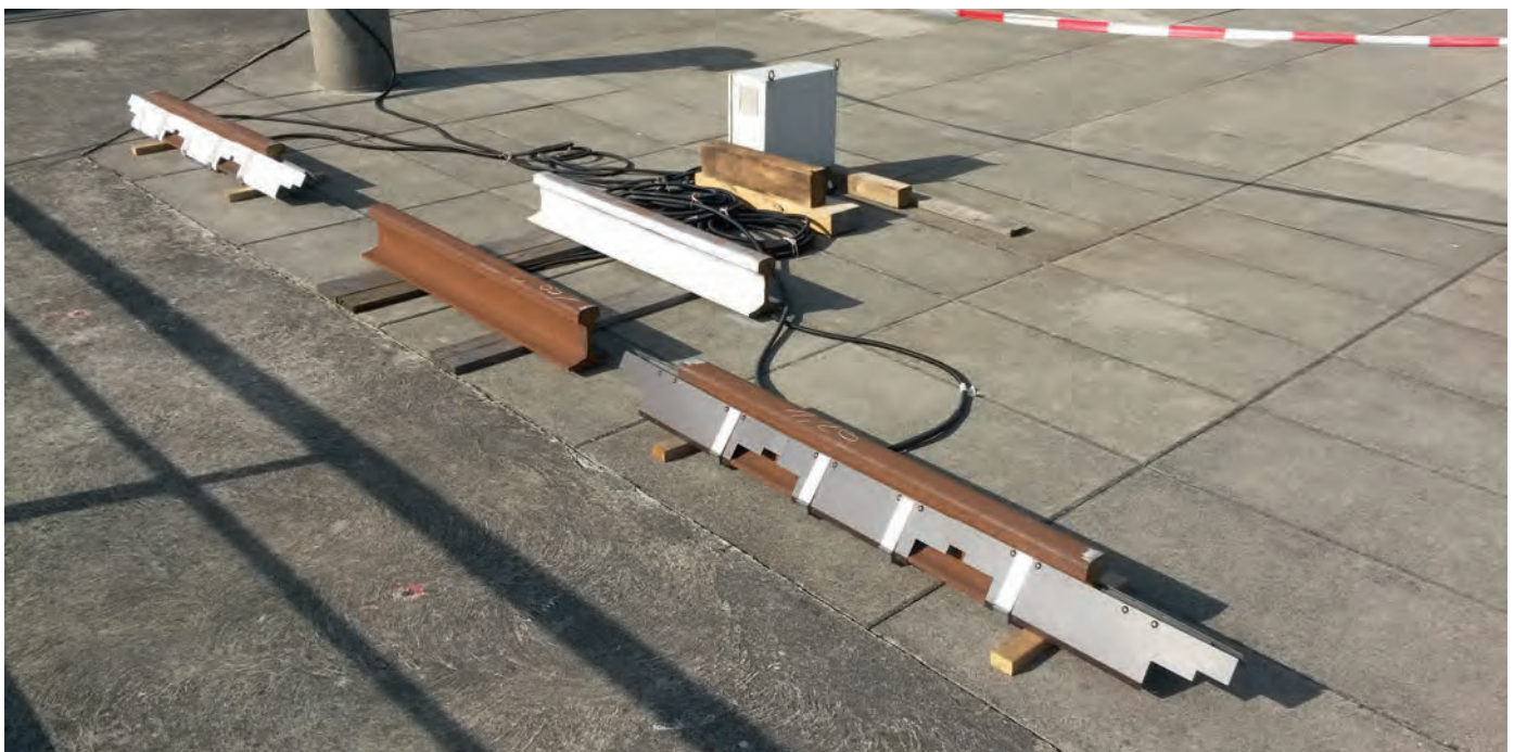
Abb. 6: Versuchsaufbau zur Messung der Schientemperatur [2]
