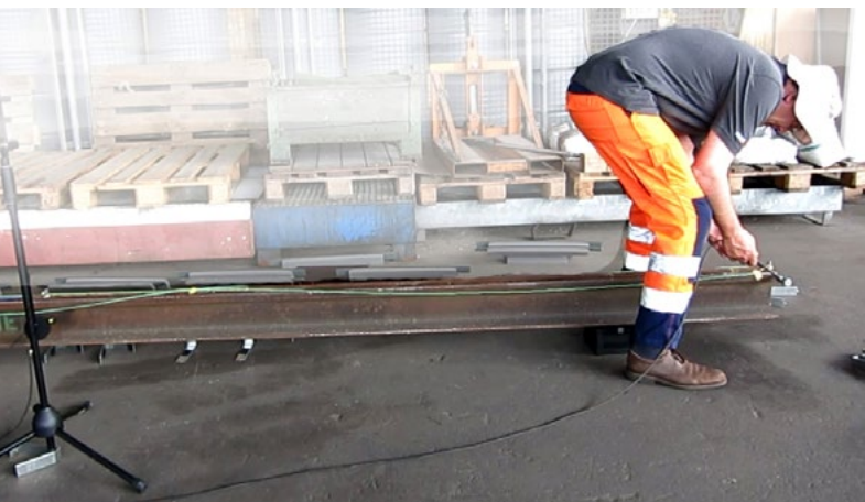
Rys. 3: Akustyczne pobudzenie szyny młotkiem impulsowym – luźno ułożona szyna o długości 6 m
