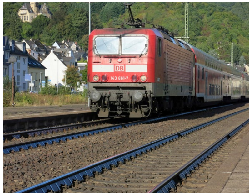
Rys. 2: Osłony dźwiękochłonne szyn na torze w Rheintal
