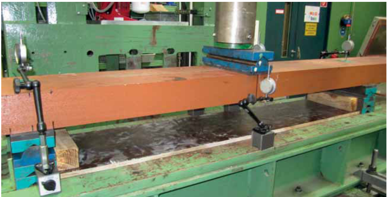
Ermüdungsprüfung in Schwellenmitte (2,0 Mio. Lastspiele)
