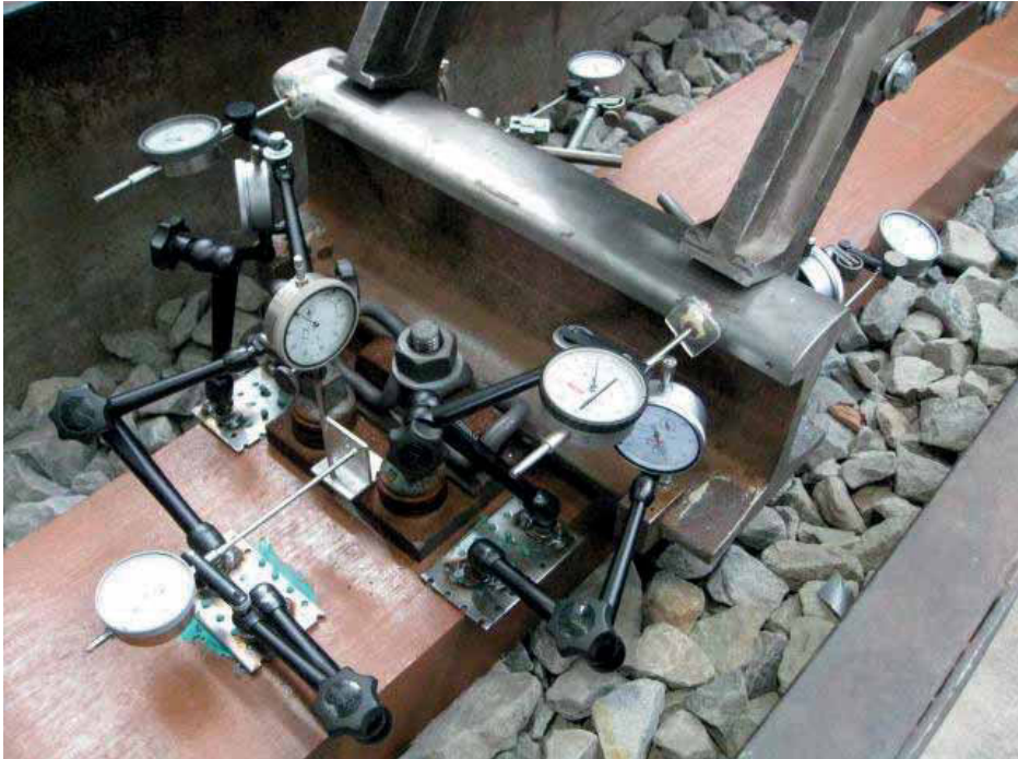
Scherenhebelschwingversuch in Anlehnung an DIN EN 13481-3
