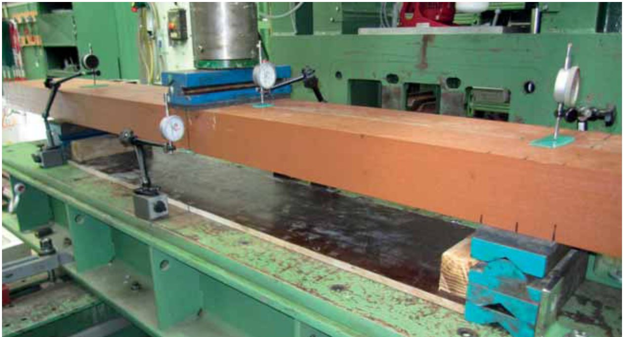
Statische Prüfung in Schwellenmitte
