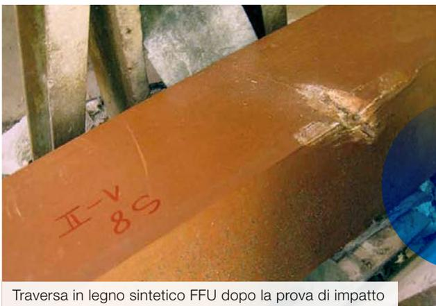
Traversa in legno sintetico FFU dopo la prova di impatto
