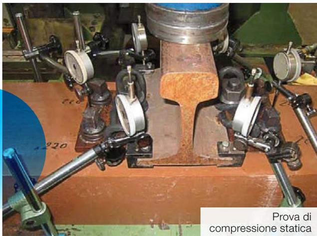
Prova di compressione statica
