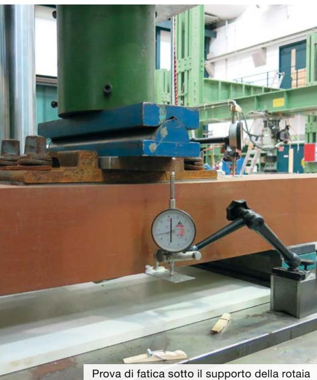
Prova di fatica sotto il supporto della rotaia
