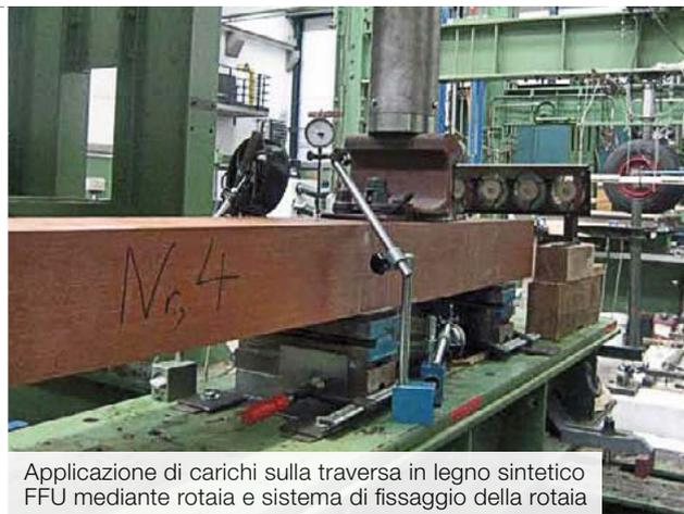
Applicazione di carichi sulla traversa in legno sintetico FFU mediante rotaia e sistema di fissaggio della rotaia
