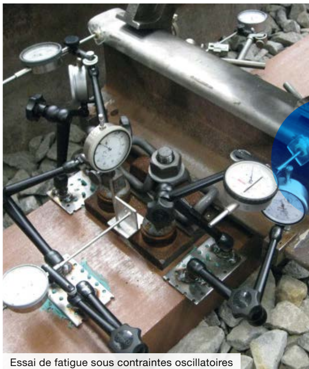
Essai de fatigue sous l'appui des rails
