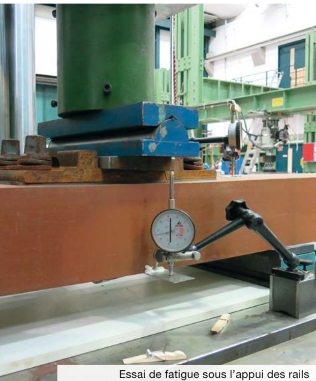
Essai de fatigue sous contraintes oscillatoires
