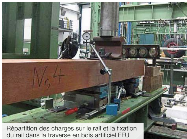
Essai de compression statique
