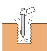
Oczyszczenie wywierconego otworu
